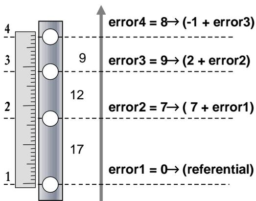
Figura 2: Hole bar errors
